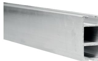
Das Aluminium-Profil ist verwindungsfrei und hat eine Wandstärke von 3,6 mm. Ab einer Länge über 6m werden Profilverbinder benötigt. Das Aluminium-Profil ist vorgesehen für die Aufnahme der frei verschiebbaren Halterungen und des Rohrübergabestützens und ist eine hervorragende Lösung für Einzelstellplätze. Es wird für sämtliche Systeme der DLS und EMS Serie verwendet.
